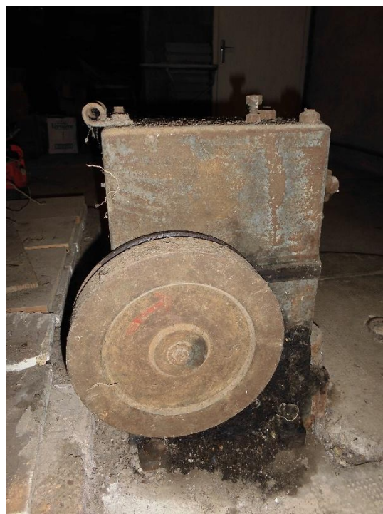
Vue coté poulie d'entraînement. On remarque la fixation du moteur dans la partie supérieure.
