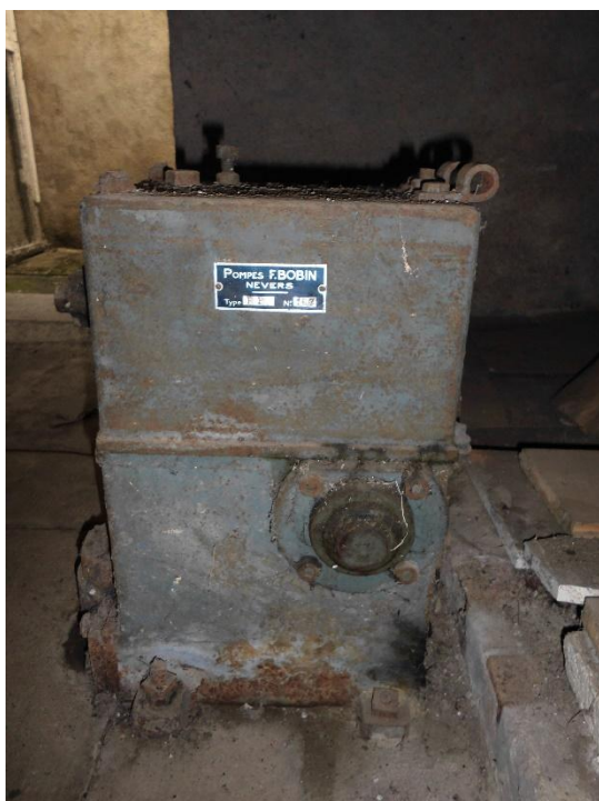
Vue coté plaque d'identification. On remarque dans la partie inférieure le support du palier d'entraînement.
